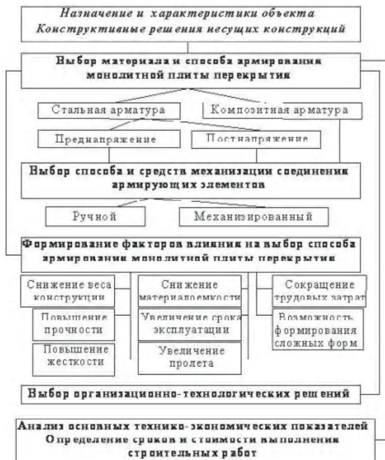
Рис. 1. Блок-схема повышения эффективности возведения монолитной плиты перекрытия
