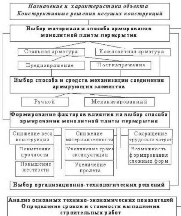
Рис. 1. Блок-схема повышения эффективности возведения монолитной плиты перекрытия
