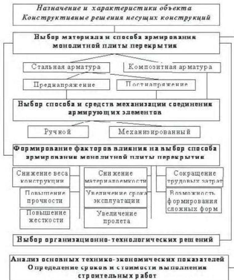
Рис. 1. Блок-схема повышения эффективности возведения монолитной плиты перекрытия
