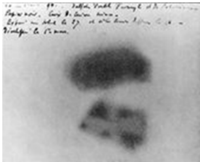
Рис. 4. Изображение фотопластинки Беккереля, засвеченной излучением солей урана. Ясно видна «тень» металлического мальтийского креста, помещённого между пластинкой и солью урана
