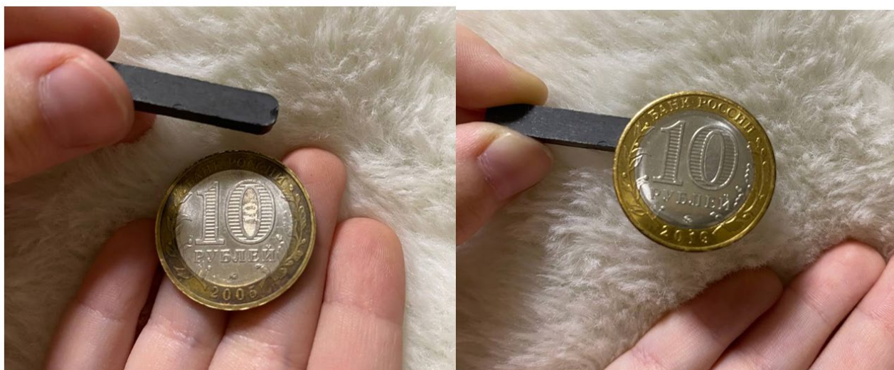
Рис. 15. Автор статьи проводит эксперимент с юбилейными монетами номиналом 10 рублей. Монета 2005 года выпуска, не притягивается к магниту (а), а монета 2019 года удерживается магнитом (б)
