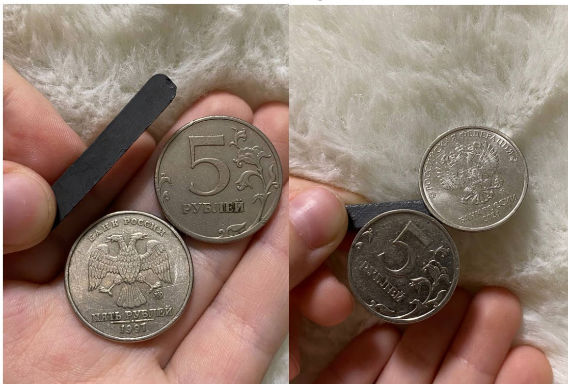
Рис. 16. Автор статьи проводит эксперимент с монетами номиналом 5 рублей. Монеты 1997 года выпуска изготовлены из меди с мельхиоровым покрытием (а), монеты 2024 года – из стали с никелевым покрытием – притягиваются к магниту (б)
