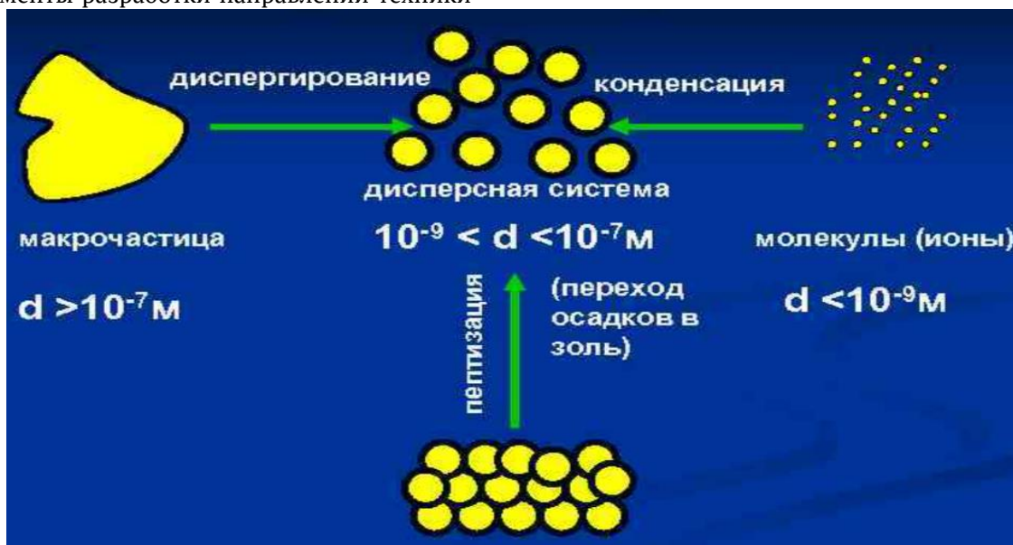
Рис. 2. Схема получения дисперсных систем [3]
