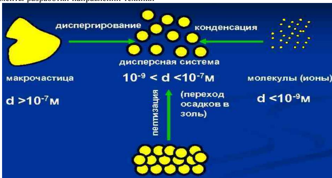
Рис. 2. Схема получения дисперсных систем [3]
