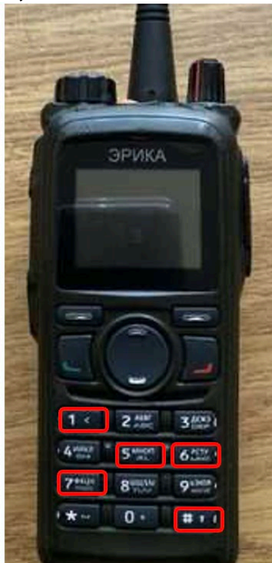
Рис. 7. Вариант разблокировки радиостанции "Эрика-360" путем ввода комбинации клавиш органов управления
