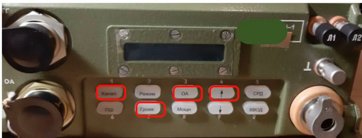
Рис. 7. Вариант разблокировки радиостанции Р-168-5УН-1 путем ввода комбинации клавиш органов управления
