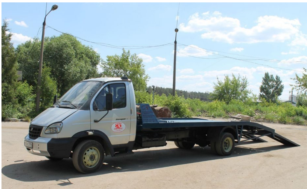
Рис. 1. Лебедочный автоэвакуатор со стационарной платформой
