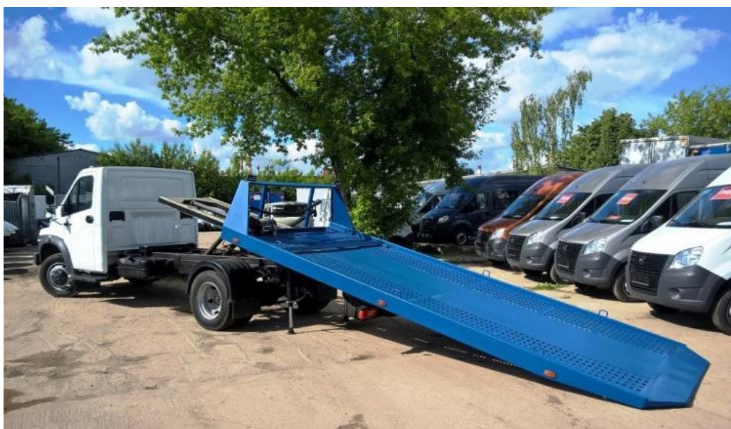
Рис. 2. Лебедочный автоэвакуатор со сдвижной платформой
