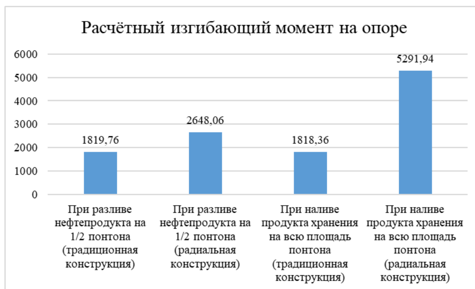
Рис. 3. Сравнительный анализ расчетного изгибающего момента на опоре в двух моделях с разными конструктивными особенностями понтона при разливе нефтяной продукции на половину и на всю площадь понтонной конструкции
