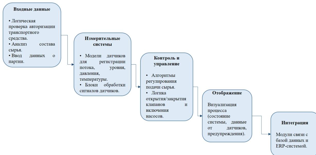
Рис. Схема для моделирования процесса автоматизации приема сырья на нефтеперерабатывающем предприятии
