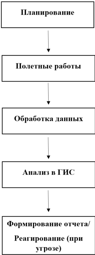
Рис. 2. Схема работы комплексной системы мониторинга трубопроводов на основе БПЛА и ГИС
