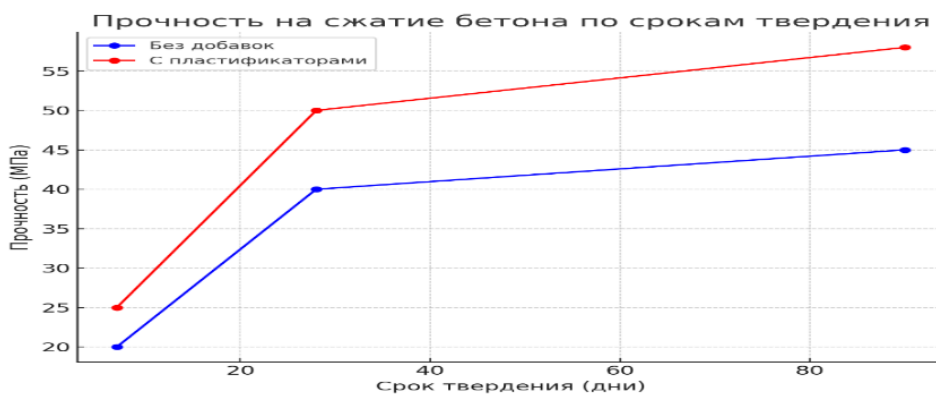
Рис. Прочность на сжатие бетона по срокам твердения (график будет показывать рост прочности для обоих типов бетона, чтобы наглядно продемонстрировать улучшения с пластификаторами)
