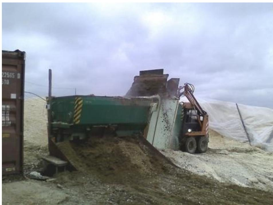
Рис. 7. Погрузка смеси в ферментер
