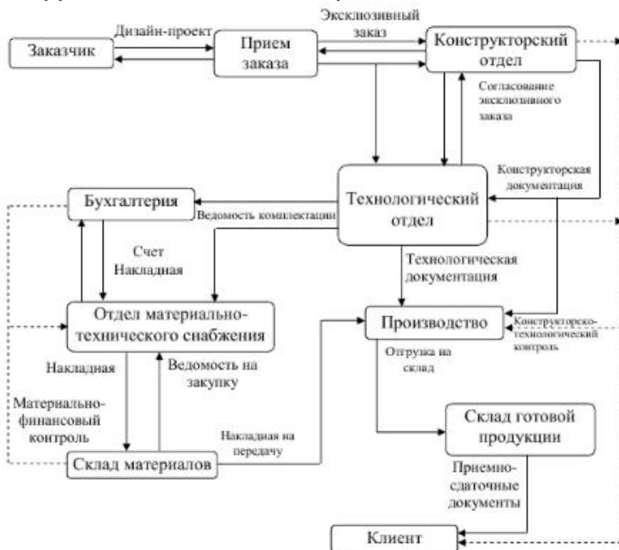
Рис. 2. Структура производственно-технологических информационных потоков мебельного предприятия
