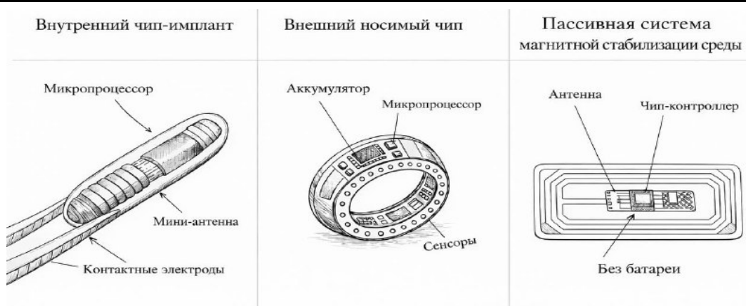
Рис. Архитектура активных и пассивных чип-систем с магнитным взаимодействием
