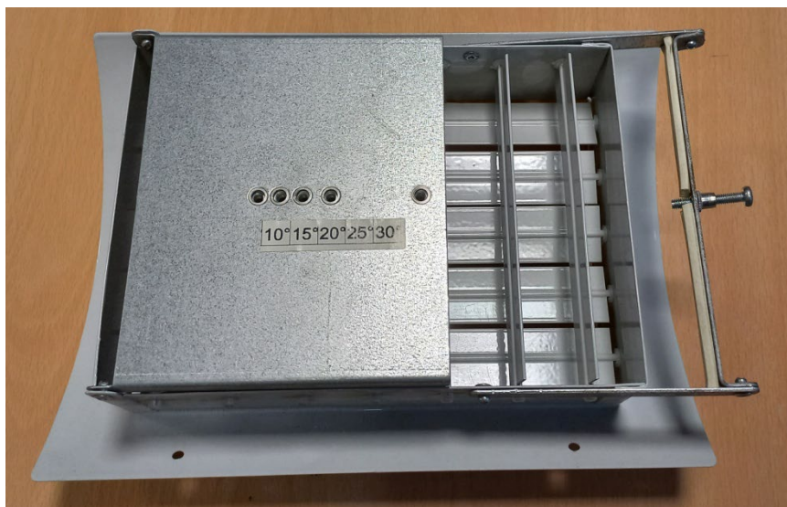
Рис. 2. Воздухораспределитель КДУ с двумя рядами жалюзи для изменения направления и характеристик приточной струи и регулятором потока
