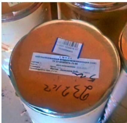
Рис. 7. Смола нейтрализованная воздухововлекающая (СНВ)
