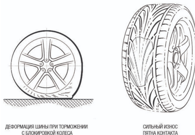
Рис. 10. Деформация шины в процессе торможения
