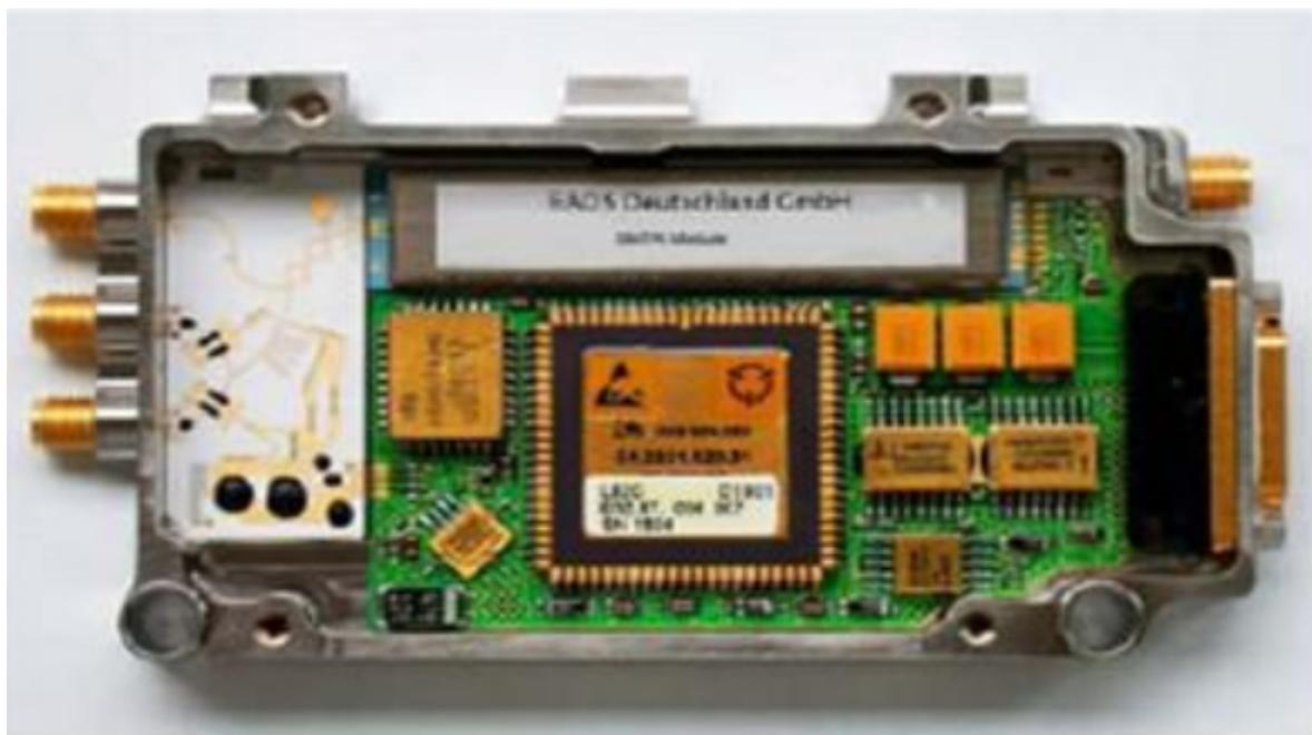
Рис. 18. Модуль СВЧ АФАР X-диапазона
