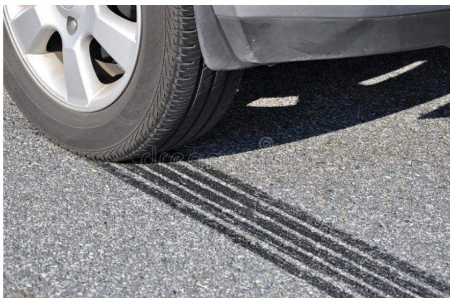
Рис. 9. Процесс совместного истирания шины и покрытия
