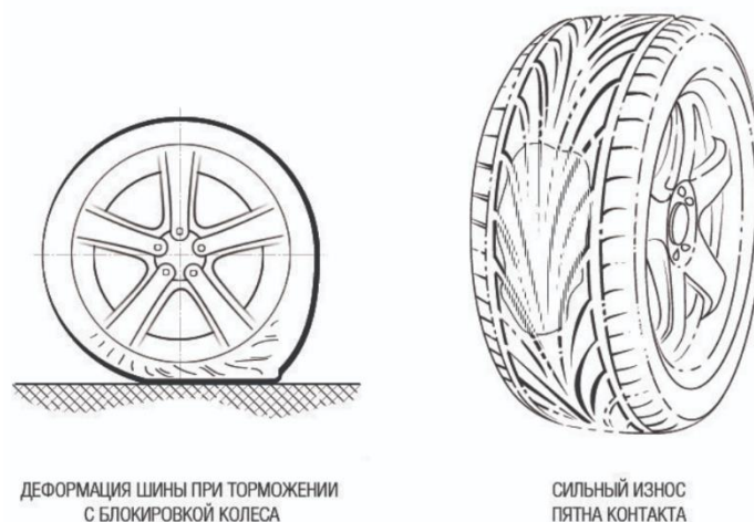
Рис. 10. Деформация шины в процессе торможения
