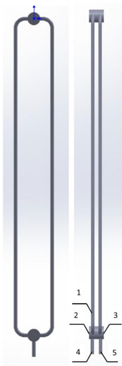
Рис. 2. Упрощенная модель отопительного прибора, смоделированная на базе SolidWorks; Вид – спереди, сбоку
