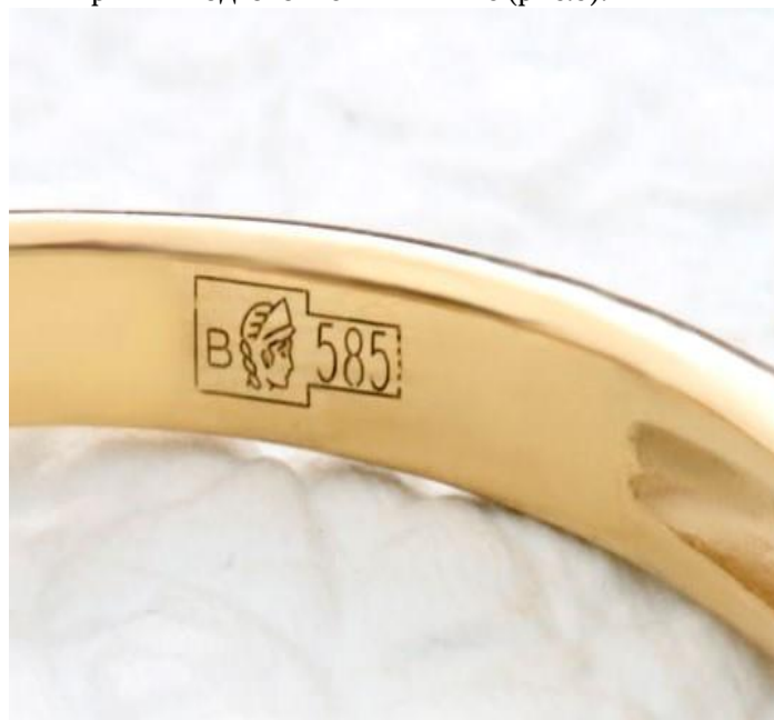
Рис. 5. Нанесение пробирного клейма лазерным способом
