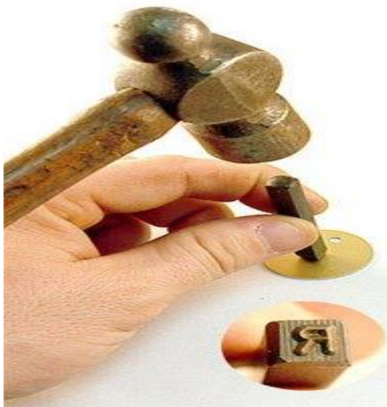
Рис. 1. Нанесение пробирного клейма ударным способом
