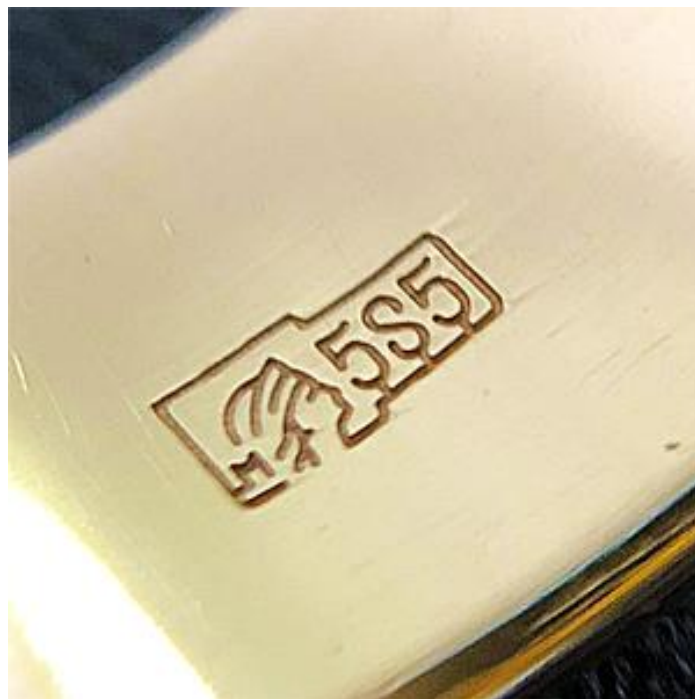
Рис. 3. Нанесение пробирного клейма электроискровым способом
