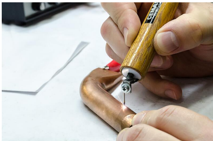
Рис. 4. Нанесение пробирного клейма при помощи электроискрового карандаша
