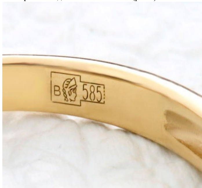
Рис. 5. Нанесение пробирного клейма лазерным способом
