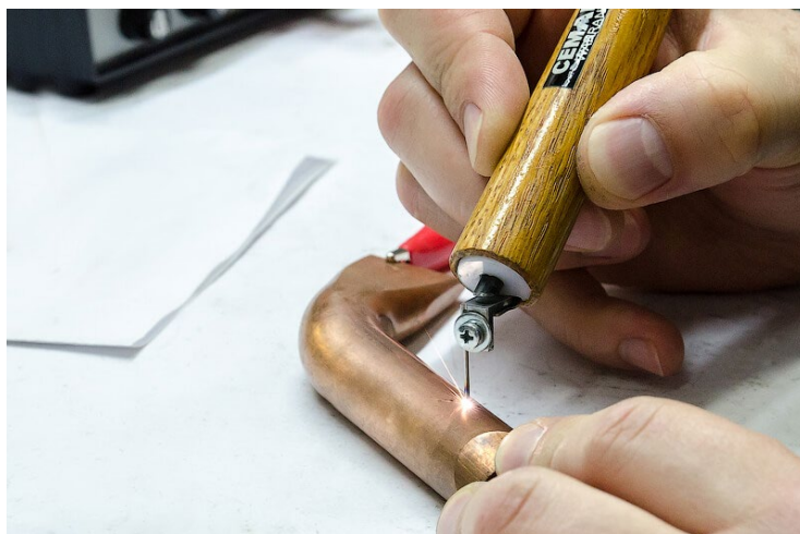
Рис. 4. Нанесение пробирного клейма при помощи электроискрового карандаша
