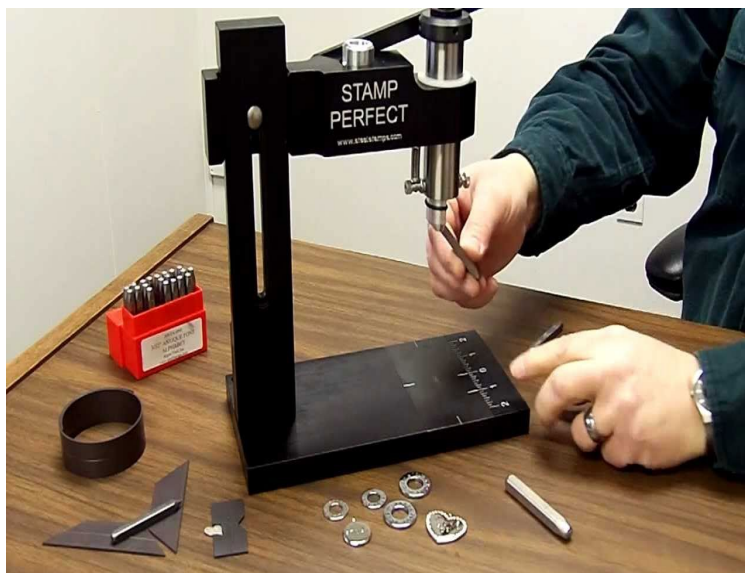
Рис. 2. Нанесение пробирного клейма ударным способом при помощи маркировочного пресса
