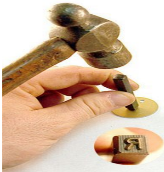
Рис. 1. Нанесение пробирного клейма ударным способом
