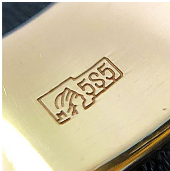
Рис. 3. Нанесение пробирного клейма электроискровым способом
