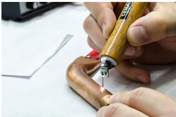
Рис. 4. Нанесение пробирного клейма при помощи электроискрового карандаша
