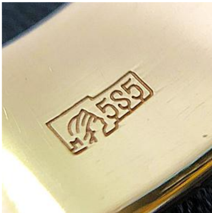
Рис. 3. Нанесение пробирного клейма электроискровым способом
