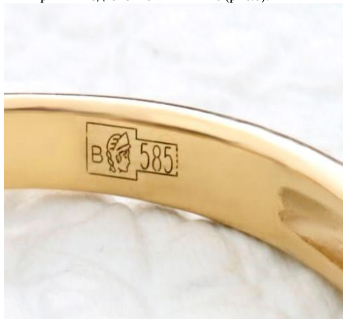
Рис. 5. Нанесение пробирного клейма лазерным способом
