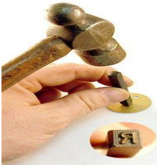
Рис. 1. Нанесение пробирного клейма ударным способом
