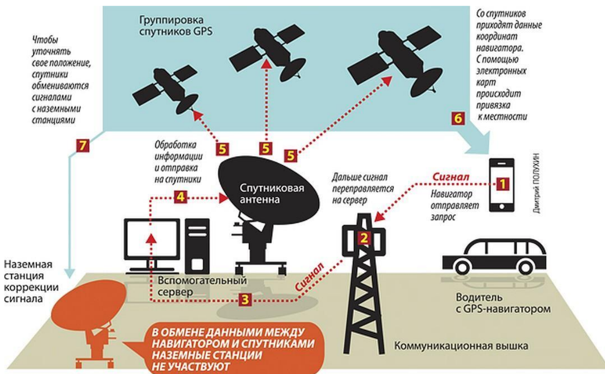
Рис. 2. Принцип и схема работы систем навигации
