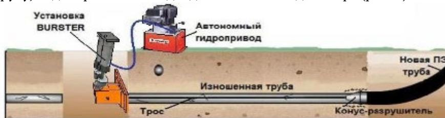
Рис. 2. Технология реконструкции «труба в трубе (с разрушением)»
