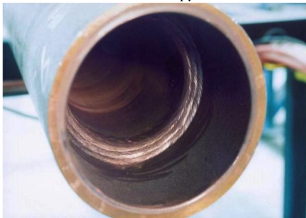
Рис. 3. Термоизолированная лифтовая труба
