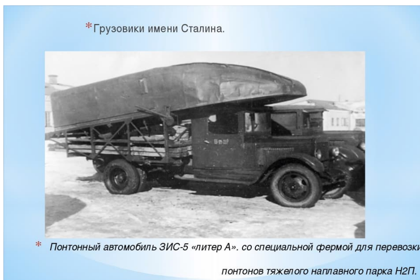
Рис. 2. Первые автомобили, использующие принцип мультилифта
