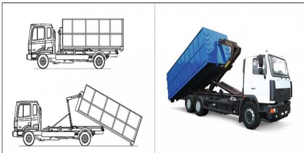
Рис. 1. Принцип работы системы мультилифт на автомобиле
