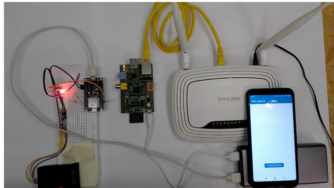
Рис. 5. Свечение красного индикатора (красного светодиода), доступ запрещён
