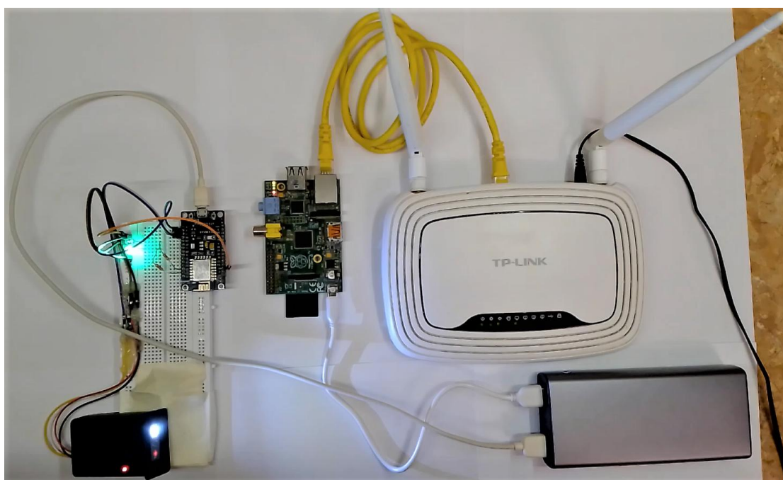
Рис. 3. Прототип «Системы контроля и управления доступом (СКУД)»
