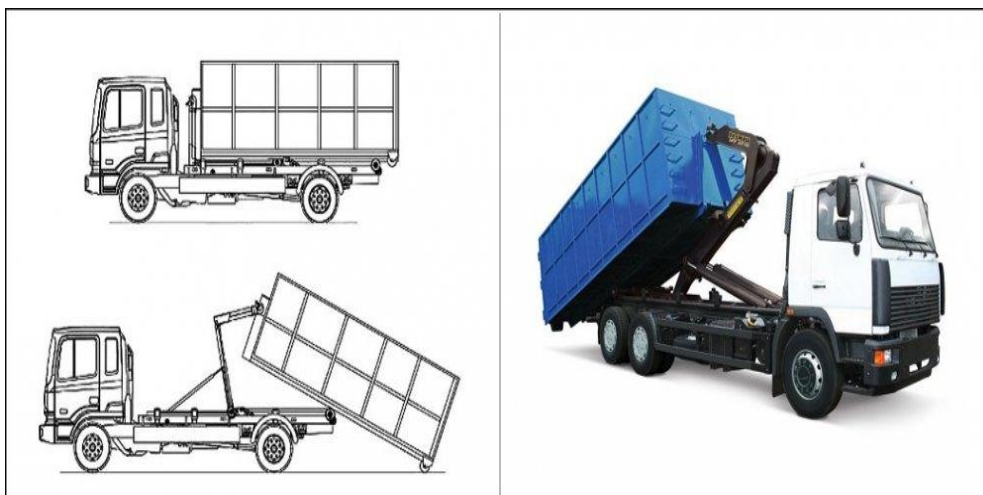
Рис. 1. Принцип работы системы мультилифт на автомобиле
