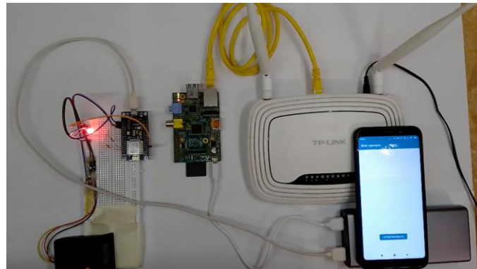
Рис. 5. Свечение красного индикатора (красного светодиода), доступ запрещён
