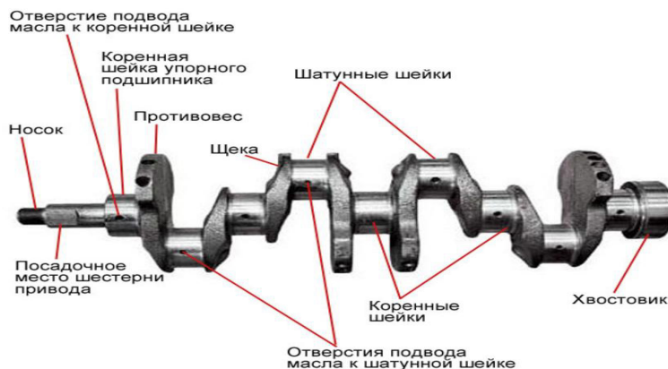
Рис. Конструкция коленчатого вала
