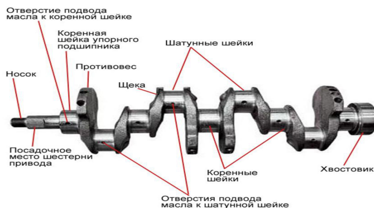
Рис. Конструкция коленчатого вала
