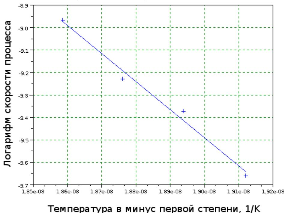
Рис. 4. Зависимость логарифма скорости процесса переэтерификации от температуры
