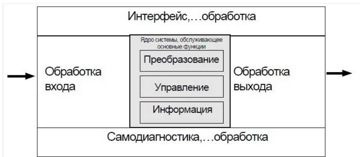
Рис. 2. Шаблон структурных блоков обработки ввода и вывода
