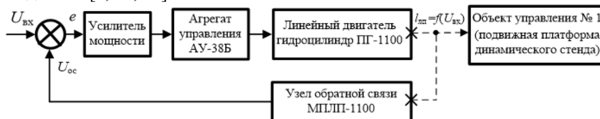
Рис. 2. Структурная схема линейного электрогидравлического привода
