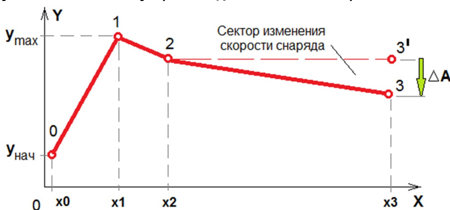
Рис. 2. График кинетического трения системы «заряд-снаряд-ствол»
