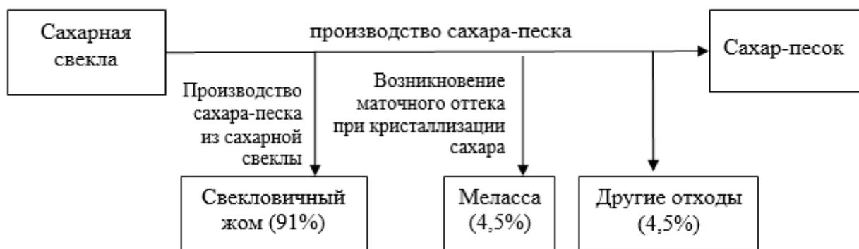
Рис. 1. Блок-схема образования вторичных отходов при переработке сахарной свеклы
