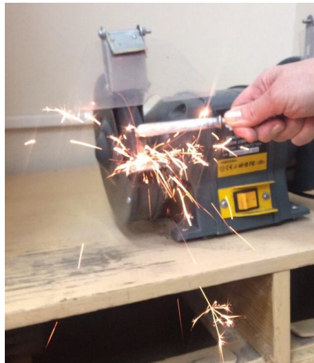
Рис. 2. Искровой поток образца № 1
