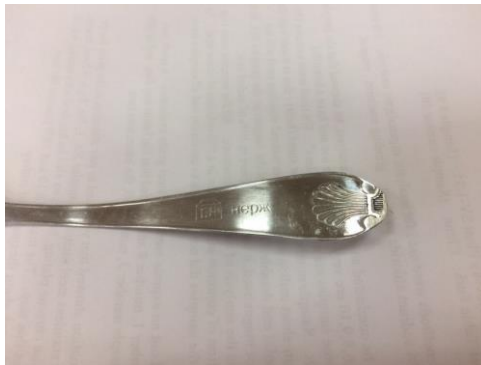
Рис. 3. Образец № 10 с маркировкой «Нерж»
