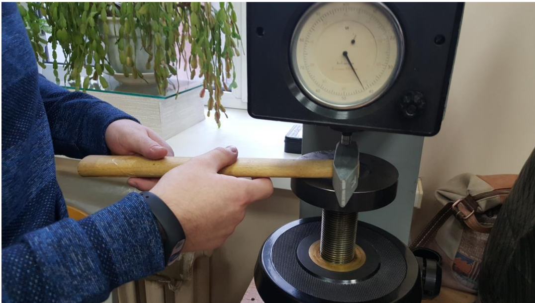
Рис. 2. Замер твердости на «ТР5006М»
