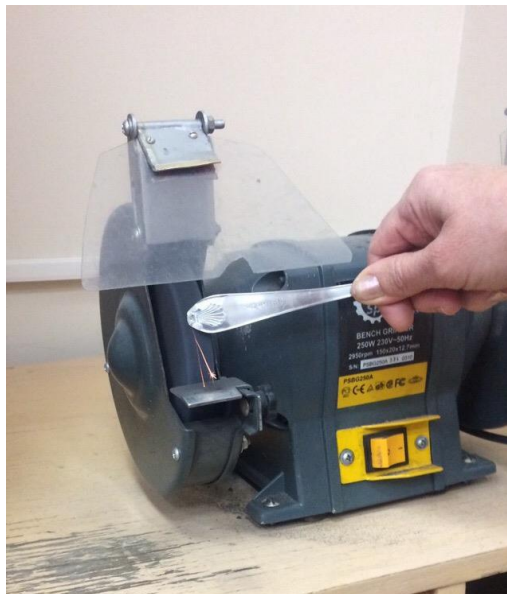
Рис. 4. Искровой поток образца № 10
