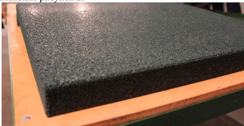
Рис. 2. Плоская кровля из резиновой крошки
