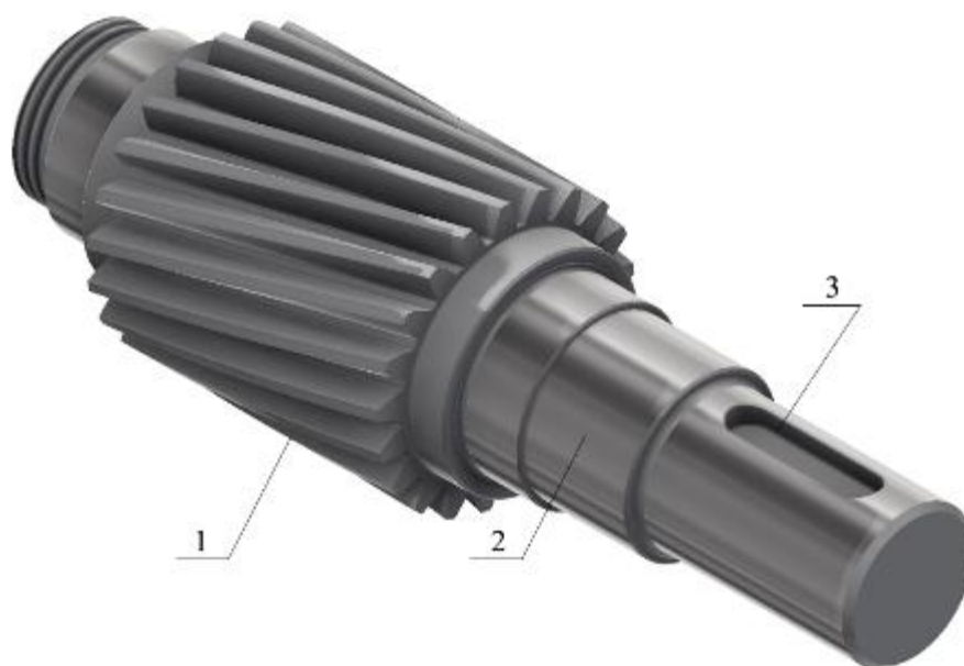
Рис. Вал-шестерня (твердотельная модель): 1 – зубчатый венец, 2 – вал, 3 – шпоночный паз
