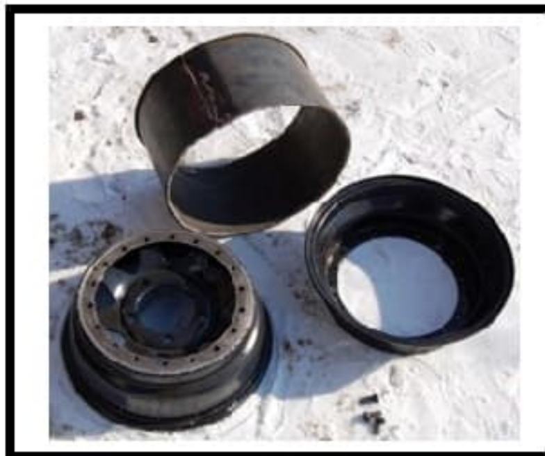
Рис. 3. Разборное колесо с распорным кольцом
