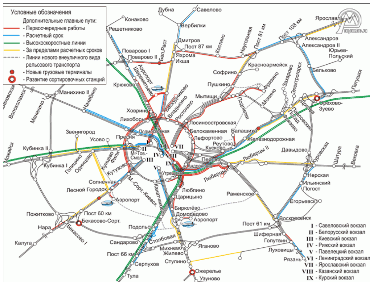
Рис. 1. Схема реконструкции МЖУ до 2025 года
