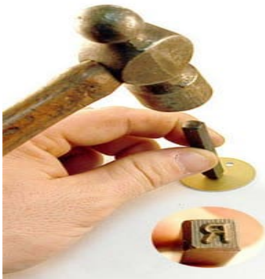
Рис. 1. Нанесение пробирного клейма ударным способом
