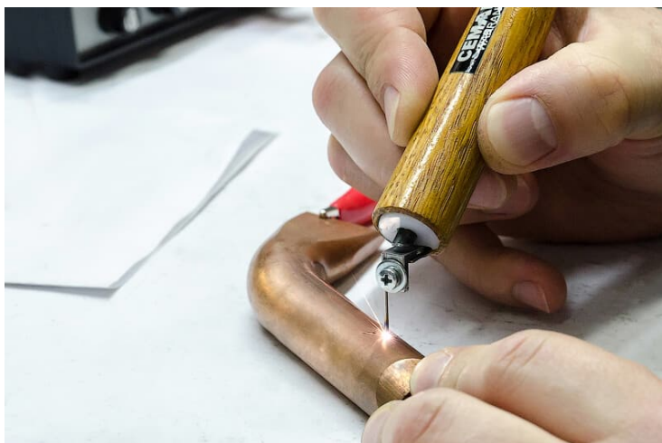
Рис. 4. Нанесение пробирного клейма при помощи электроискрового карандаша
