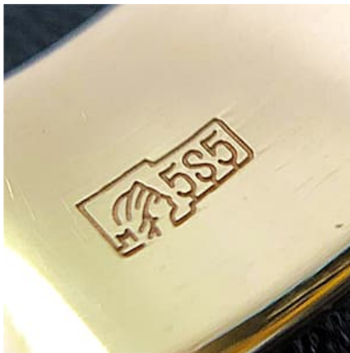
Рис. 3. Нанесение пробирного клейма электроискровым способом
