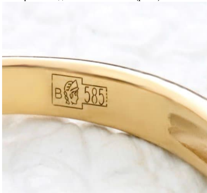
Рис. 5. Нанесение пробирного клейма лазерным способом
