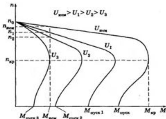
Рис. 3. Механические характеристики асинхронного двигателя при изменении напряжения подводимого к обмоткам статора
