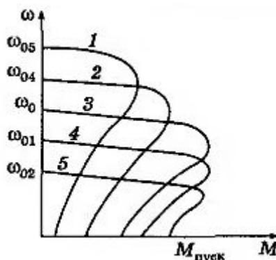
Рис. 6. Механические характеристики асинхронного двигателя при частотном регулировании
