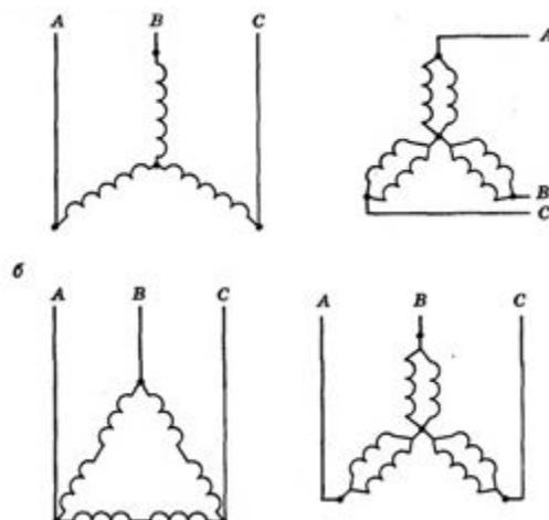
Рис. 7. Схемы переключения обмоток асинхронного двигателя:
