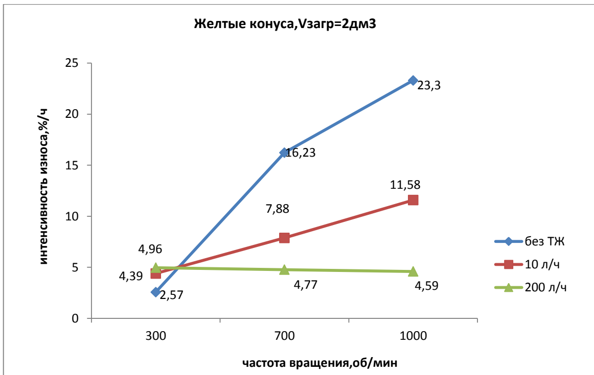
Рис. 5. Зависимость интенсивности износа абразивных частиц «желтый конус» от частоты вращения и объема подаваемой жидкости
