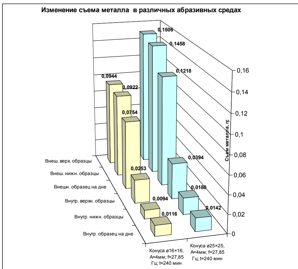
Рис. 3. Изменение съема металла в зависимости от размера абразивных гранул и расположения образцов при ВиО (амплитуда A=4 мм)
