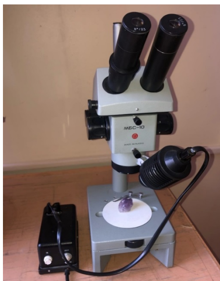
Рис. 1. Оптический металлографический микроскоп
