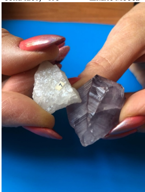
Рис. 8. Определение твердости друзы из аметиста по шкале Мооса
