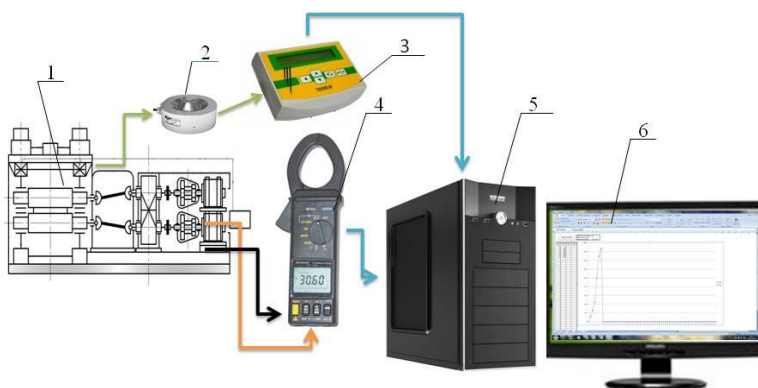
Рис. 2. Общая схема учебно-исследовательского комплекса. 1 – лабораторно-прокатный стан, 2 – тензодатчик М70 К, 3 -весоизмерительный преобразователь ТВ-014, 4 – клещи-ваттметр АТК-2104, 5 – системный блок, 6 – монитор
