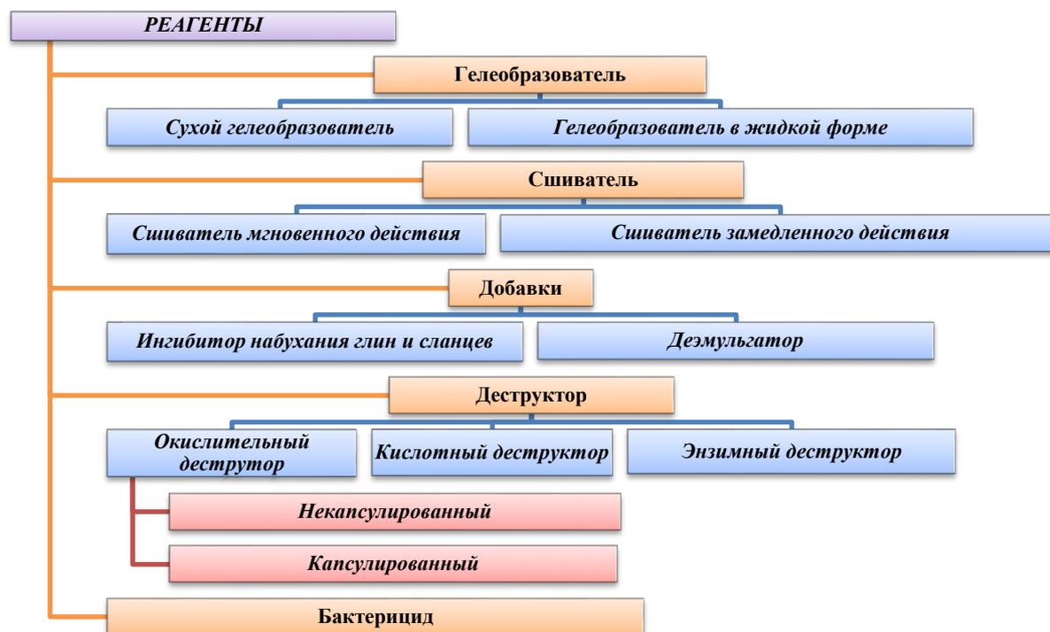
Рис. 1. Комплекс химических реагентов для получения жидкости ГРП на водной основе производства ЗАО «Петрохим»
