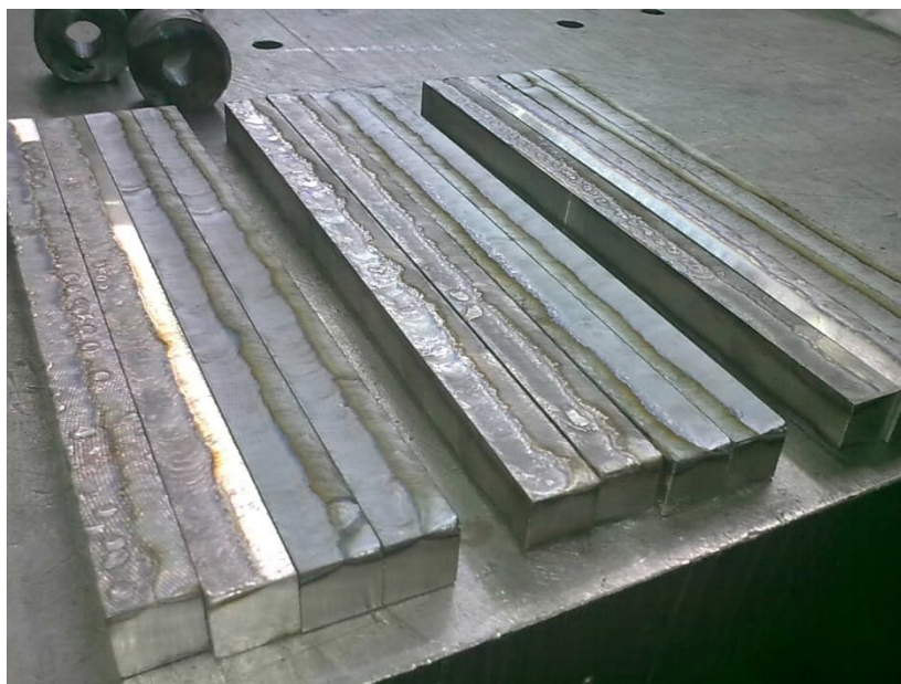
Рис. 3. Плазменная закалка на экспериментальных деталях
