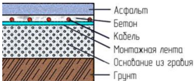
Рис. Установка электрической системы обогрева
