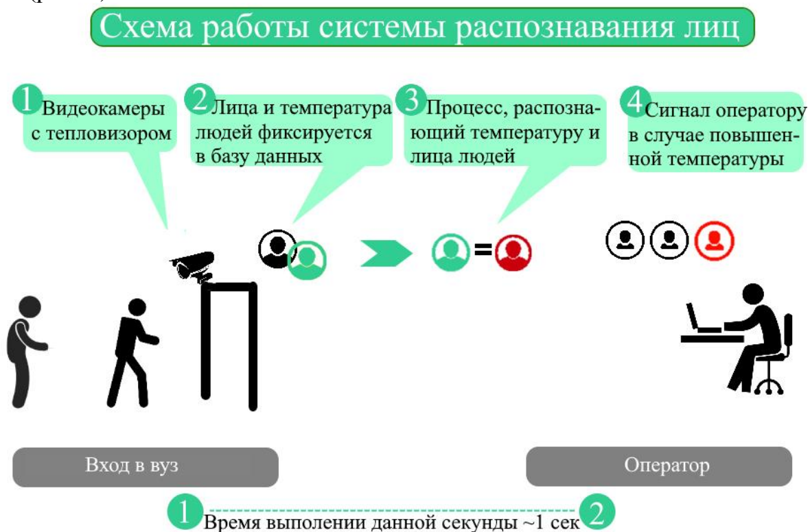
Рис. 2. Схема работы системы распознавания лиц
